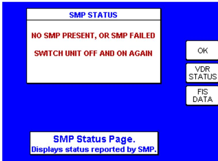
FIGURE 4-125 SMP Status Page (No SMP Detected)
