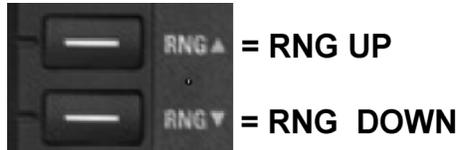
**FIGURE 4-3 RNG (Range) UP/DOWN Detail**
